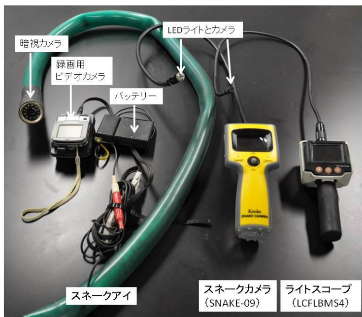
図1: 著者が作成したスネークアイとLED ライト付き防水ファイバースコープ2機種
