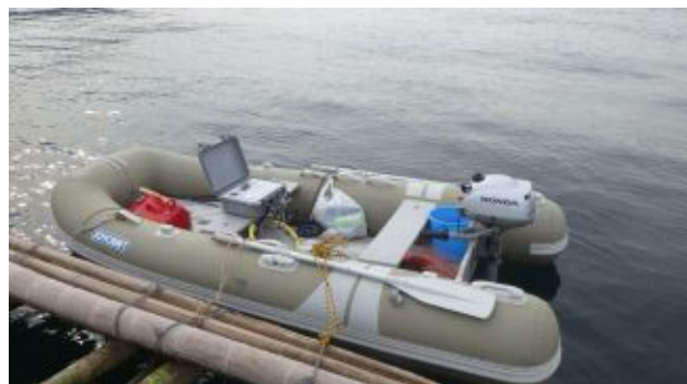
図 3. 追跡用のボート。追跡中は、左手で船外機を操作し、右手で指向性ハイドロフォンを操作する。
